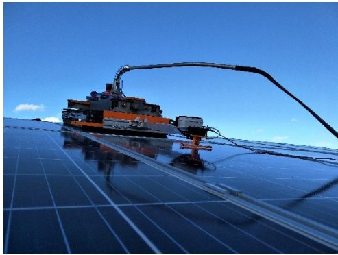
Abbildung 8: Links: PV-Reinigungsroboter mit integriertem Messgerät für Magnetfelder (Foto: DENKweit GmbH). Rechts: Gemessene Magnetfeldverteilung zeigt den unterbrochenen Stromfluss in einem der Busbars der Solarzellen (Grafik: DENKweit GmbH)
